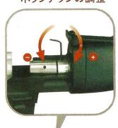
カバーアクスルピンのロックを解除しトップカバー を外します。前方にあるホップアップ調整スクリュー を6角レンチで締め込みホップアップ運を調整します。 スクリューを締込む程ホップアップは強くなり スクリューを緩めるとホップアップは弱くなります
