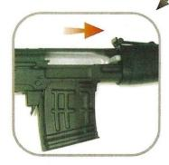
ボルトレバーをストックの方向へストッパーに 当たって止まるまで引きます。その後ボルト レバーを離すと銃身方向にレバーが移動し 元の位置に戻ります。
